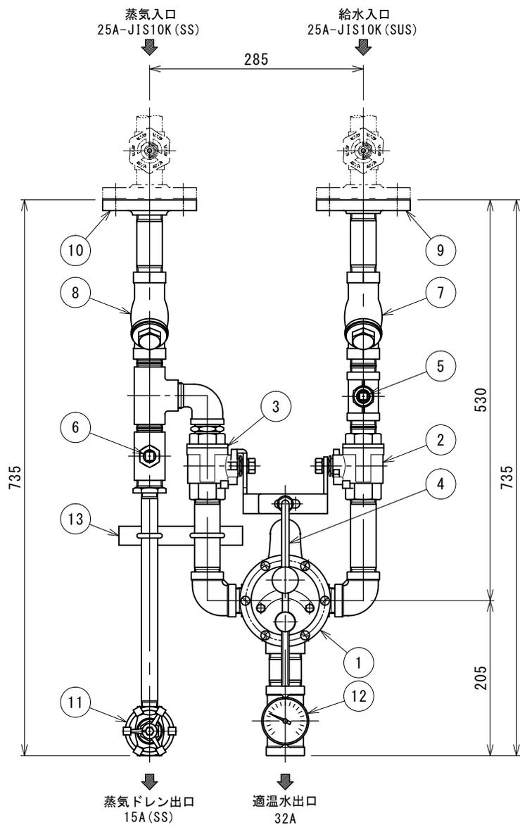
△ バルブは現場手配の上必ず取り付けてください。流量調整が必要な場合はグローブ弁を推奨します。
