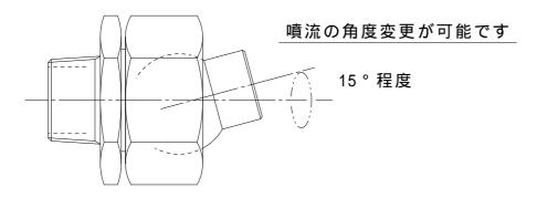
方向可変ノズルの可変範囲
