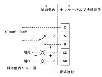
SWがS側でバルブ閉(ポジション①) SWがO側でバルブ開(ポジション②)
