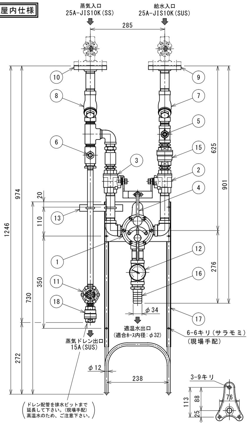
バルブは現場手配の上必ず取り付けください。流量調整が必要な場合はグローブ弁を推奨します。
