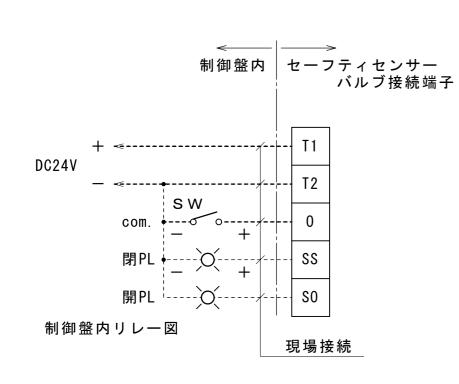
出力信号負荷電流 DC24V 4A~33mA
