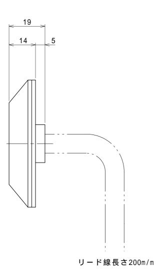
埋込ミニ押釦 常開形(a接点) (防沫形プレート・リード線付) 3A 30V
