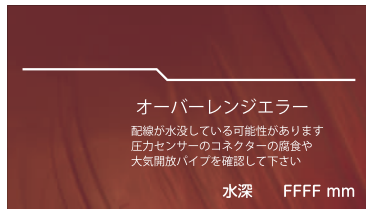
15-5 エラー画面（腐食 / 水没）
