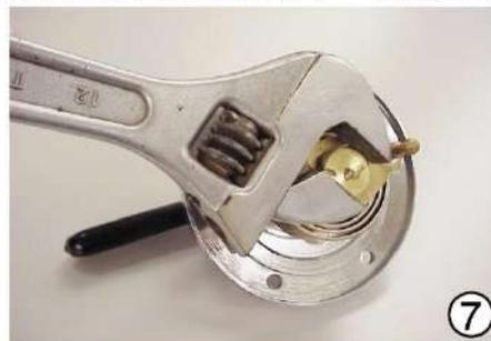
コイルスリーブスタッドをモンキーレンチで反時計方向に廻して取り外します。
