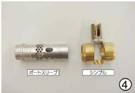
シンプルの内側とポートスリーブの外側に付着したスケールなどをクレンザーなどで落として下さい。腐食がひどい場合は交換して下さい。
