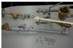
ナットを外した状態です。間にパッキンが付属していますので、取付時再度組み込んでください
