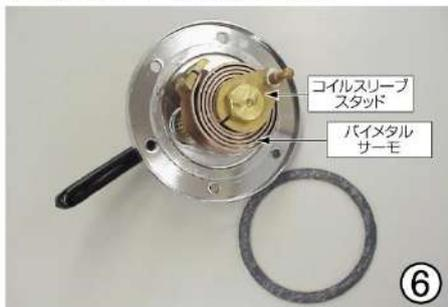
カバーの裏側に温度調整する為のバイメタルサーモを取り付けています。
