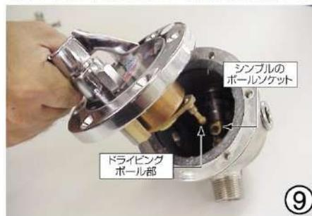
カバーに取り付けているバイメタルサーモの凸部の先端(ドライビングボール)をシンプルのボールソケット部に確実に差し込んで下さい。
