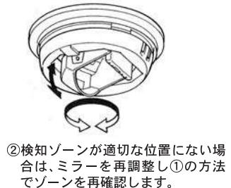
②検知ゾーンが適切な位置にない場合は、ミラーを再調整し①の方法でゾーンを再確認します。
