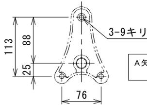
A矢視図(バックプレート取付穴)
