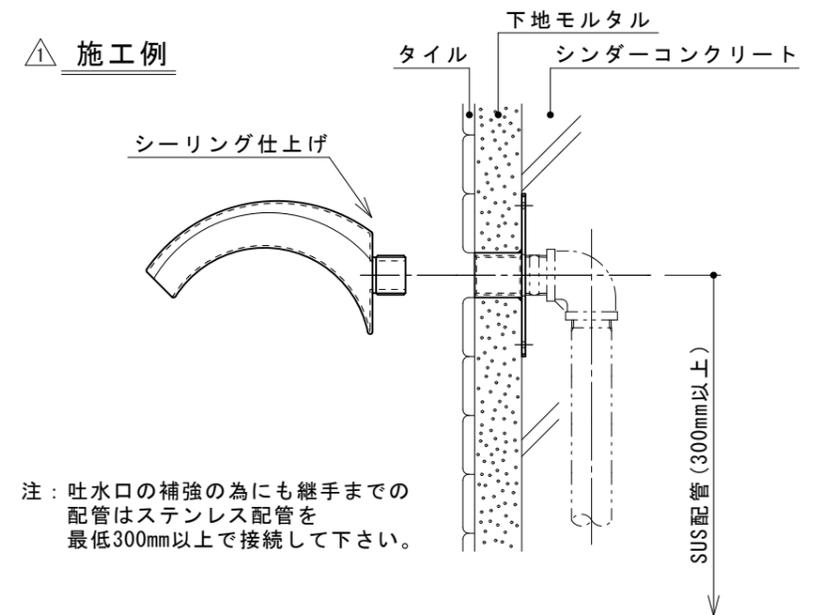
注：吐水口の補強の為に継手までの配管はステンレス配管を最低300mm以上で接続して下さい。
