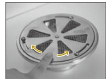
中心のビスと、楕円形穴のビスをゆるめ、目皿をスライドすることで開口部の流量調整ができます。
