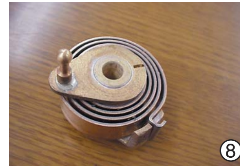
⑧ バイメタルコイルの表面が黒くなったりしている場合、家庭用の酢に20分程度つけて下さい。取り出した後には水洗いして下さい。 ※腐食がひどい場合は交換が必要です。
