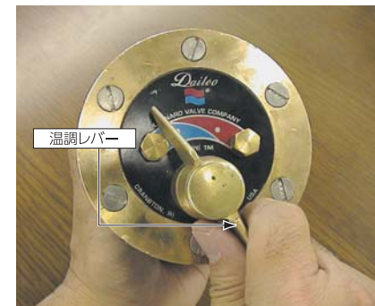
⑧ バイメタルコイルの表面が黒くなったりしている場合、家庭用の酢に20分程度つけて下さい。取り出した後には水洗いして下さい。 ※腐食がひどい場合は交換が必要です。
