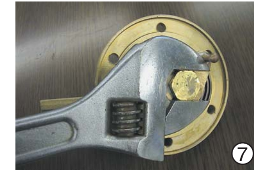
⑦ コイルスリーブスタッドをモンキーレンチで反時計方向に廻して取り外します。
