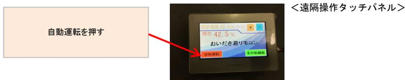
A-4 浴槽水位が水位制御コントローラで設定した目標値まで適温水が補給され補給が停止することを確認してください。
