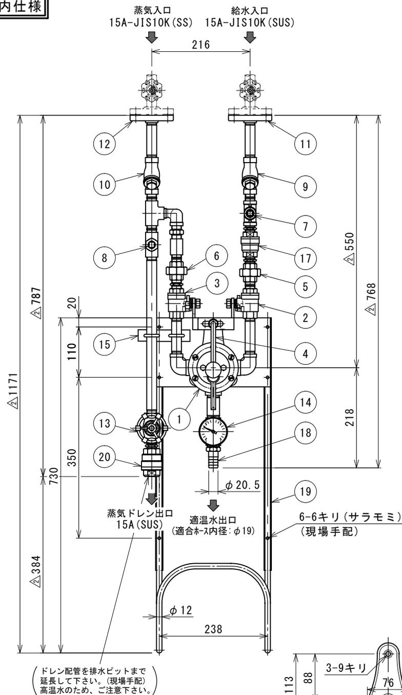
△ バルブは現場手配の上必ず取り付けてください。流量調整が必要な場合はグロブ弁を推奨します。
