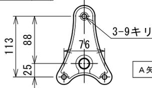
A矢視図(バックプレート取付穴)
