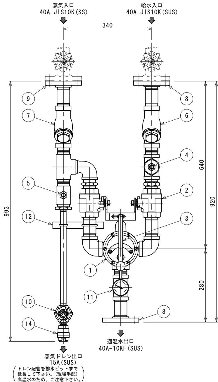
△ バルブは現場手配の上必ず取り付けてください。流量調整が必要な場合はグローブ弁を推奨します。
