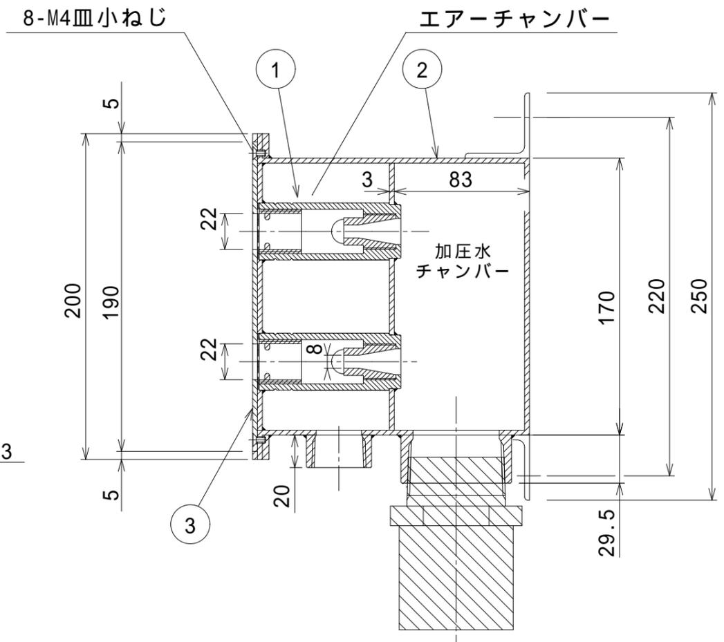
設計流量 300ℓ/min 圧力 0.2MPa時
