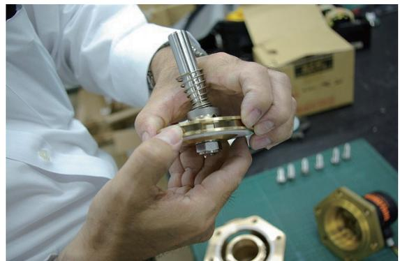
テーパーにカットされている方向を上向きにして下さい。次にピストンリング 2 本を順番にピストンリングスプリングの上に乗るようにセットします。2 本のピストンリングの切れ目は上下同じ位置にならないように、お互い反対側に切れ目があるようにセットします。
