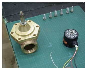
本体と上蓋部を2分割されます。ボルトの取り外し作業がやり辛い場合は上蓋部に付いているコイル部を外して下さい。この場合必ず電源が切れていることを確認して下さい。通電されるとコイルが焼損する場合があります。
