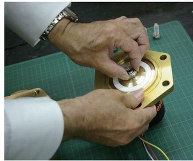
スムーズに動かない、動きに抵抗を感じる場合はピストン部が収納されている上蓋部の周囲やピストンリング、ピストンリングスプリングを確認して下さい。上蓋部の内側にヘルメシール材などが付着している場合は除去し、細かなキズなどある場合はサンドペーパー 1000 ～ 1500 番程度で面をきれいに磨いて下さい。
